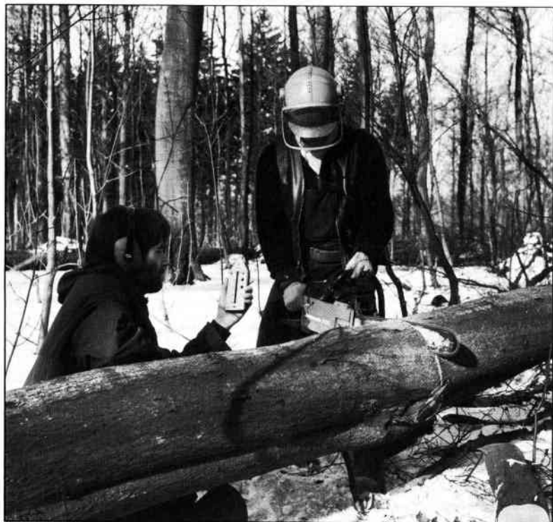
Fig. 1.4. Mesure des niveaux de vibration transmis par le manche d'une scie électrique en utilisant un accéléromètre et un mesureur de vibration
