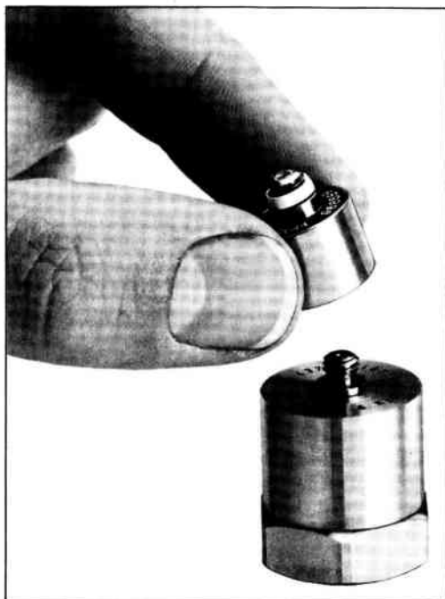
Fig. 3.17. Montage de l'Amplificateur Line-drive Type 2644 sur un accéléromètre
