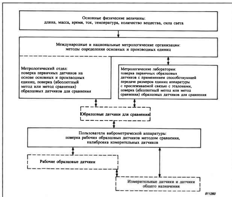
Рис. 5.4. Общая схема подчинения эталонов и образцовых вибродатчиков
