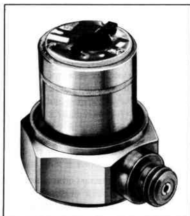
Рис. 2.7. Изготавливаемый и выпускаемый фирмой Брюль и Кьер акселерометр со встроенным усилителем-возбудителем линии передачи. Верхняя часть корпуса акселерометра устранена с тем, чтобы показать внутренний электронный блок
