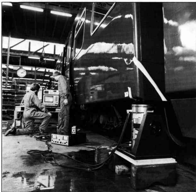
Рис. 1.3. Исследования динамических характеристик и мод колебаний железнодорожного вагона с применением виброиспытательной аппаратуры
