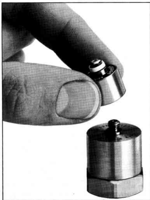
Рис. 3.17. Усилитель-возбудитель линии передачи 2644 фирмы Брюль и Кьер закрепляется сверху корпуса акселерометра
