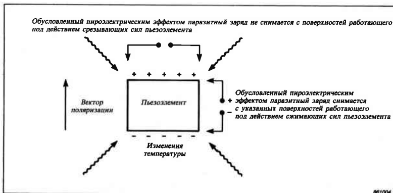
Рис. 4.4. Иллюстрация влияний быстрых изменений температуры на пьезоэлектрический материал, работающий под действием соответственно срезающих и сжимающих сил. Показанный паразитный электрический заряд обусловлен пьезоэлектрическим эффектом и вообще не связан с механическими колебаниями
