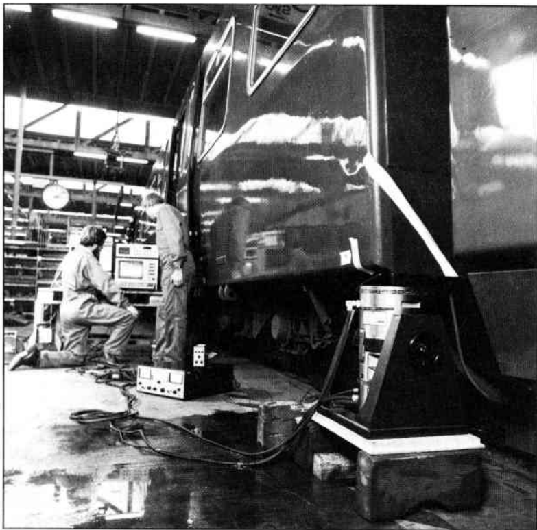
图1.3. 利用振动测量对机车车辆进行结构分析
