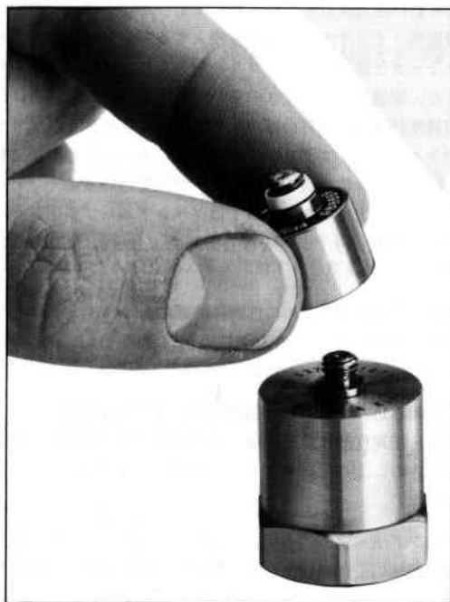
図3.17 加速度計上部へのラインドライブアンプ2644型の取り付け。
