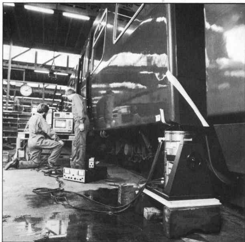
図1.3 振動測定による車両の構造の解析。
