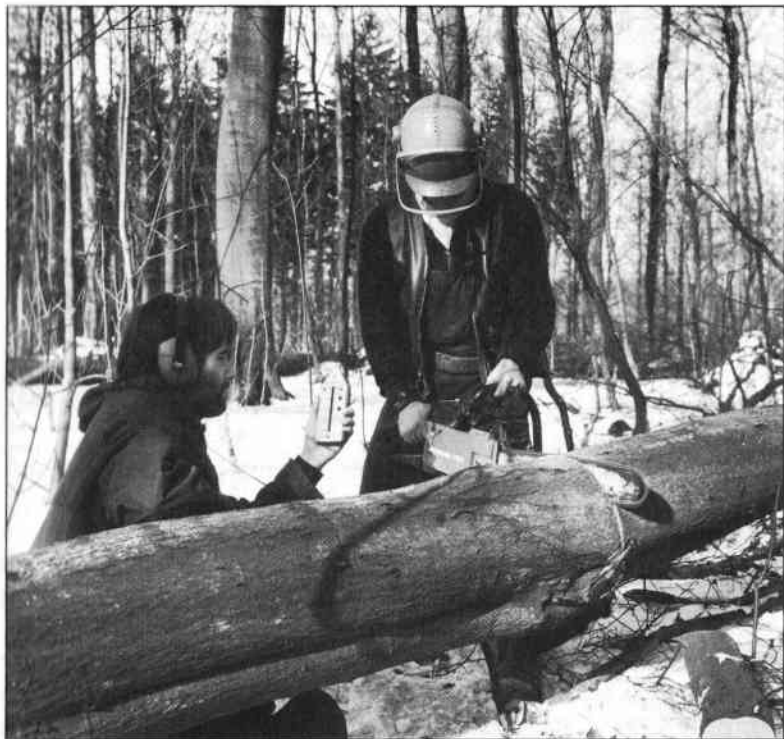
図1.4 加速度計と振動計を使ってチェーンソーのハンドルの振動レベルを測定している。
