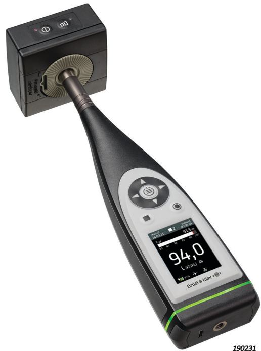
Fig. 2 Type 4231 placé sur le B&K 2245 Sonomètre. Le centre de gravité du Type 4231 est situé près du microphone, procurant une bonne stabilité à l'ensemble
