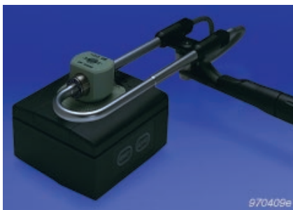
Abb. 6 Druck-Kalibrierung mit dem akustischen Kalibrator
