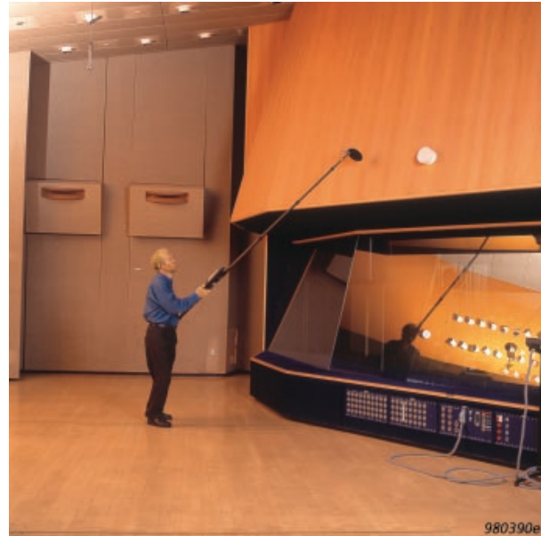
Abb. 10 Kartierung der Schalldämmung, um Lecks zwischen Studio und Regieraum zu finden
