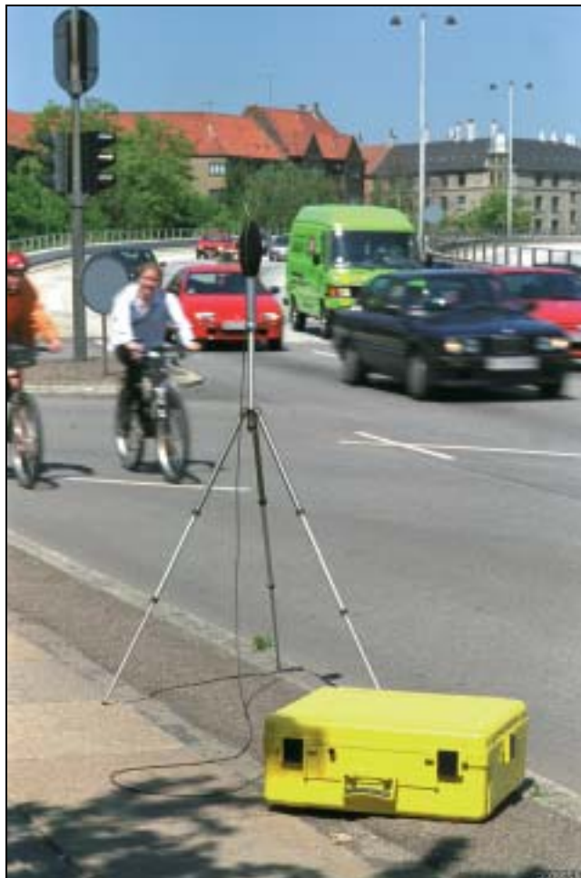
Mesurage du bruit de trafic routier sur une grande artère au moyen du Système 2260 Outdoor Gear
