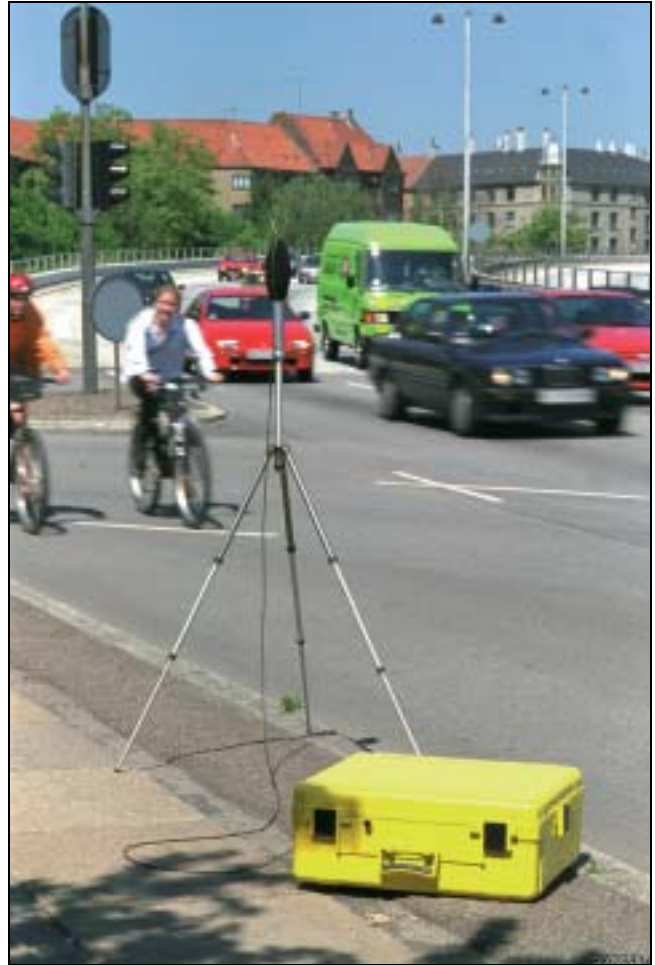
Das 2260 Outdoor Gear bei der Messung von Verkehrslärm an einer belebten Straße
