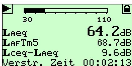
Auch Taktmaximal, Statistikfunktionen und Rücklöschung stehen zur Verfügung. Sieben L<sub>N</sub>-Werte (von L<sub>1</sub> bis L<sub>99</sub>) können beliebig zur Anzeige gewählt werden. Die Pegelhäufigkeitsverteilung wird mit jeder Messung gespeichert und steht für die spätere Analyse zur Verfügung, z.B. über einen PC mit Brüel & Kjær-Software 7820 Evaluator, 7825 Protector oder 7815 Noise Explorer.
