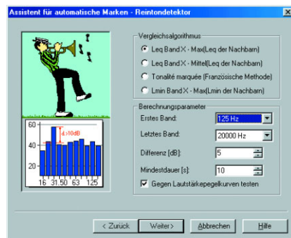
Abb. 6 Bestimmung der Tonhaltigkeit mittels eines protokollierten Terzspektrums mit einem der Assistenten für automatische Markierung
