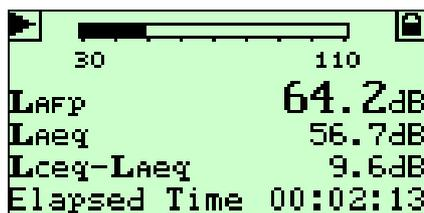
*Fig. 3 Il display del software avanzato BZ 7125. Notare che i valori ponderati A e C sono disponibili simultaneamente. I due rilevatori RMS misurano simultaneamente con costanti temporali F, S e I in parallelo*
