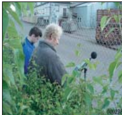
Fig. 4 Uso dell'analisi FFT per valutare il contenuto tonale del rumore lungo il perimetro di un impianto industriale
