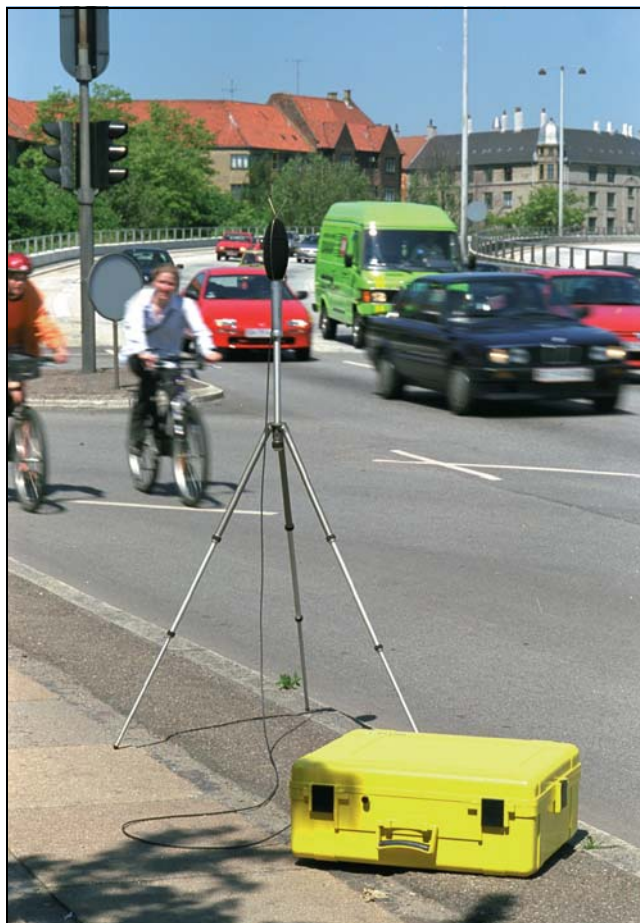
Gruppo accessori per 2260, durante la misura del rumore in una strada urbana ad alta densità di traffico
