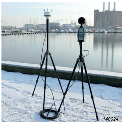
Fig. 15 Sonomètre-analyseur mesurant les bruits extérieurs à l'aide d'un kit de station météorologique
