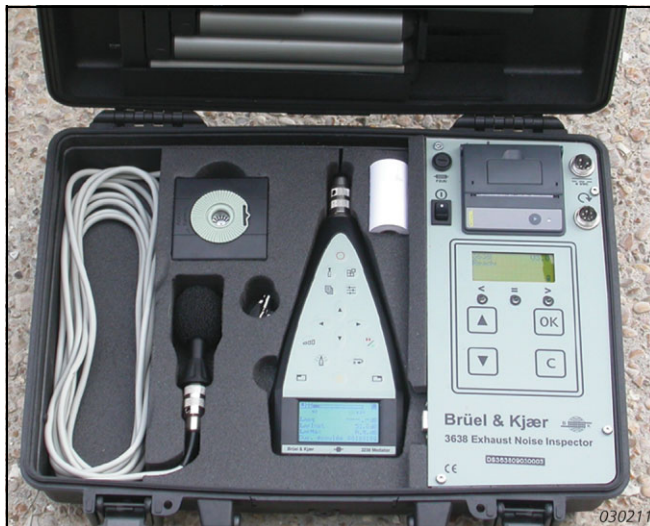
Fig. 8 Maleta completa que incluye: sonómetro, calibrador y tacómetro opcional
