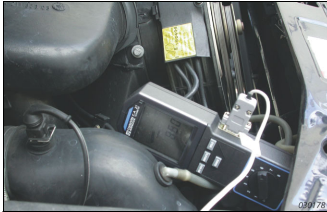
Fig. 7 Tacómetro externo colocado al lado del motor
