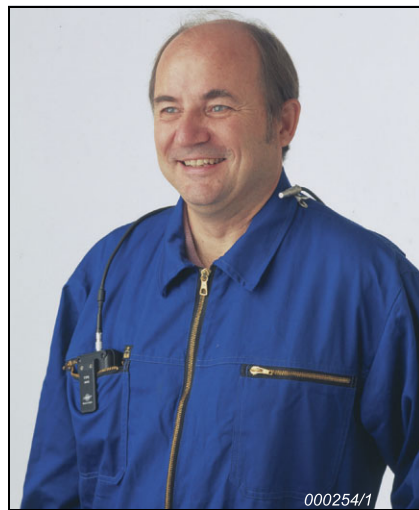
Fig. 1 Il microfono può essere agganciato al colletto e il dosimetro infilato nel taschino frontale
