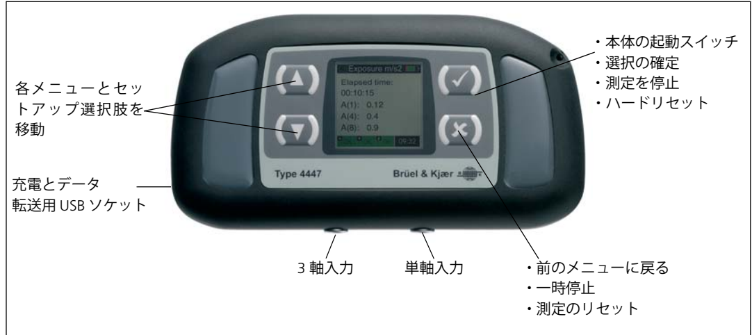
図 1 フロントパネル上の 4 つのボタンで 4447 型のユーザーインターフェースをコントロール
