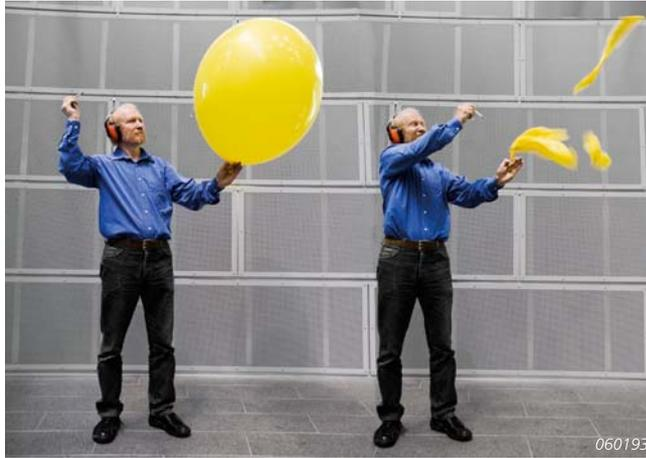
Con la excitación impulsiva, lo único que se necesita llevar es de Tipo 2250-F, un trípode y un globo (u otra fuente de impulsos, como una pistola de foguero). En cuanto explota el globo, el Tipo 2250-F comienza a realizar la medición, analiza las caídas y presenta el TR y las curvas de caída en todas las bandas de frecuencia.
