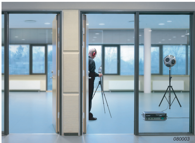
Fig. 7 Medición del tiempo de reverberación mediante el método de interrupción del ruido
