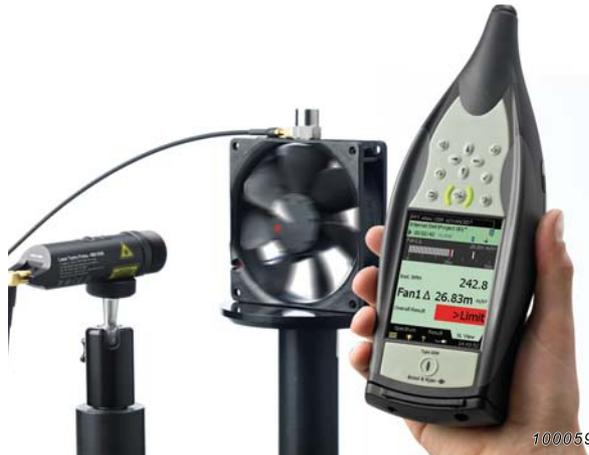
Au cours de la phase de développement, vous pouvez évaluer les performances des composants afin d'en améliorer la conception. L'affichage par superposition du sonomètre-analyseur FFT permet de comparer aisément les mesures liées aux versions consécutives du prototype.
