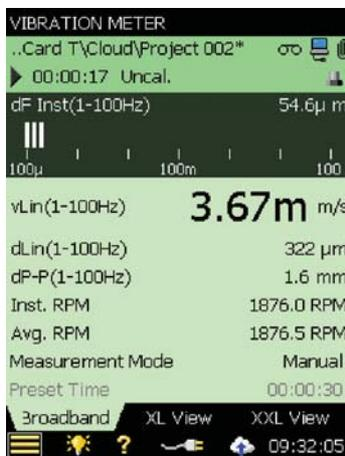
Les vibrations sont généralement mesurées en unités de vitesse (po/s ou mm/s) ou de déplacement (Mil et mm) ce qui est particulièrement usuel dans les opérations de maintenance, de réparation et de révision des machines de valeur comme les turbines à gaz et les compresseurs.
