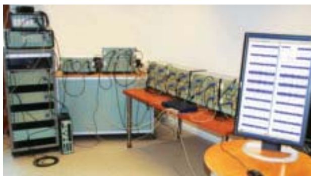
現在までで最大構成の721ch PULSEシステム
