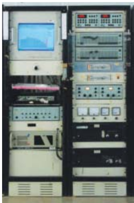
ブリュエル・ケアーは40年以上NALをサポートしてきました。NALの音響テスト設備で稼働しているランダムノイズ発生器、マルチプレクサ、スペクトルシェーパ、電圧計…
