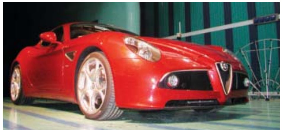
音源探査試験中のAlfa Romeoの新しい8C Competizione
