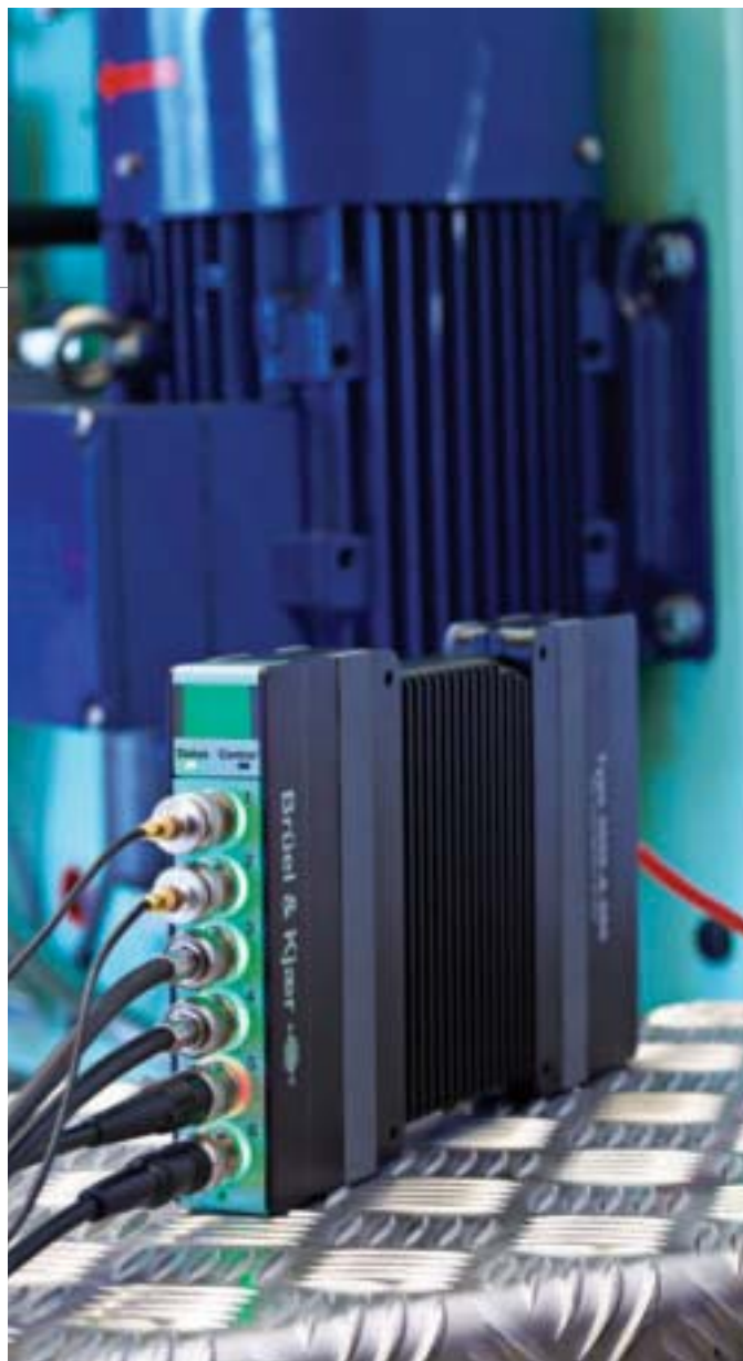
LAN-XIはデータ転送、電源供給、サンプル同期を1本のケーブルで行います
