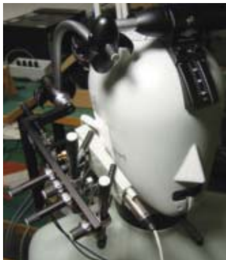
ブリュエル・ケアー HATS Type3.3イヤークミュレータのインピーダンス測定
