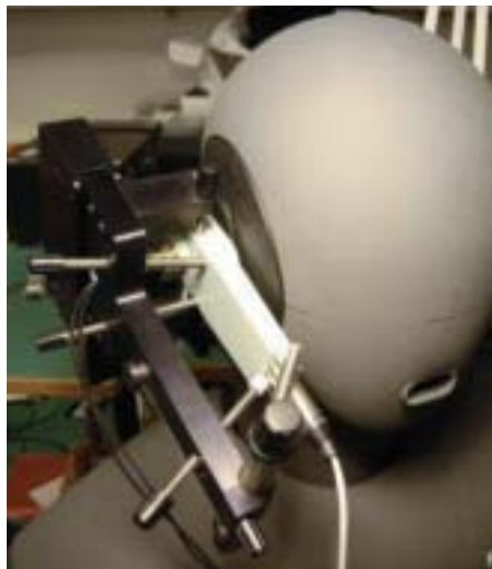
Head Acoustics社 HATS Type3.4イヤークミュレータのインピーダンス測定
