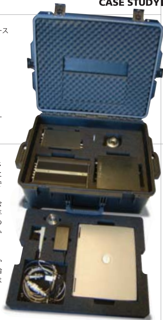
全ての計測に使用された携帯電話型のインピーダンスプローブ
