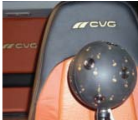
車室内で360度マップを収録するために運転席に置かれた50ch球形ビームフォーミング
