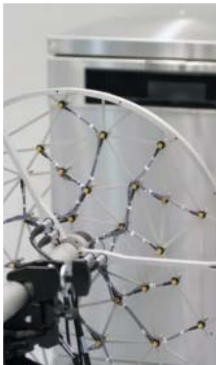
VDEの典型的な測定対象物に最適化された36chのホイールアレイ
