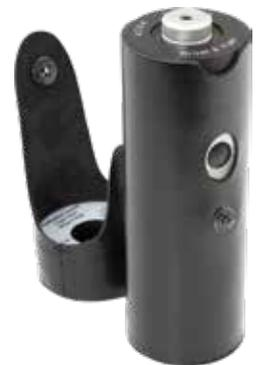
ブリュエル・ケアーは、音響振動計測のエキスパートとして、皆様の音響振動計測を効率良く、信頼性の高い計測をおこなって頂ける様、支援します。測定現場において、測定システムに接続された計測用マイクロホン、振動ピックアップの感度確認、及び、システム全体の動作確認には、校正器による検証作業は重要です。
