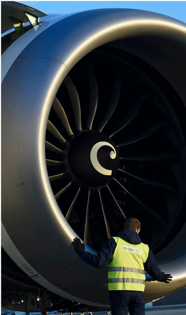
Sichtprüfung einer Triebwerksgondel
