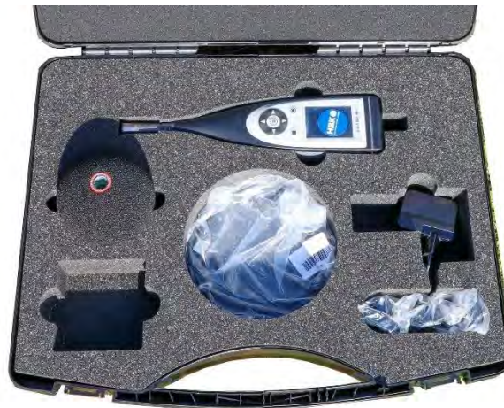
Abbildung 1: Schallpegelmessgerät 2245 mit Zubehör im Koffer
