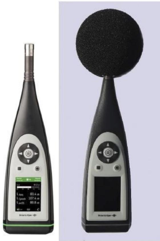
Figura 2 — Sonómetro sem e com para-vento
