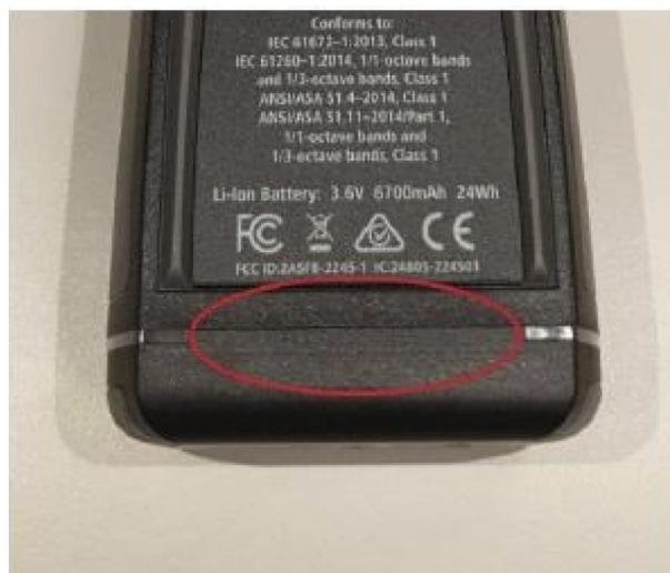
Figura 3 — Ponto de selagem na parte traseira do dispositivo
