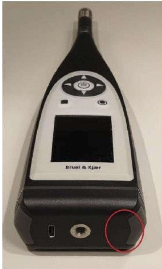
Figura 4 — Ponto de selagem na tampa dos parafusos da caixa
