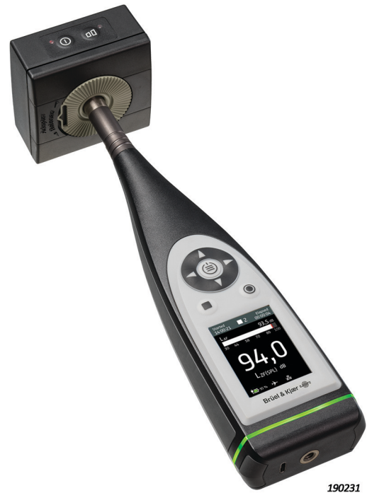
Fig. 2 Der Typ 4231 mit dem B&K 2245 Schallpegelmesser. Der Kalibratorschwerpunkt ist dicht am Mikrofon, so dass das Kalibriersystem stabil ist
