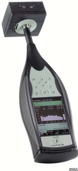
Fig. 2 Der Typ 4231 mit dem handgehaltenen Analytator Typ 2250. Der Kalibratorschwerpunkt ist dicht am Mikrofon, so dass das Kalibriersystem stabil ist
