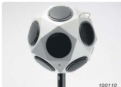
La Source sonore OmniPower 4292-L (Fig. 1) est une enceinte dodécaédrique dotée de 12 haut-parleurs orientés tous azimuts pour un rayonnement omnidirectionnel uniforme du bruit. Tous les haut-parleurs sont reliés par un réseau série-parallèle assurant leur fonctionnement en phase et l'adaptation de l'impédance à l'amplificateur de puissance. Cette source, d'une masse ne dépassant pas 8 kg, est munie d'une poignée qui n'intervient pas de manière mesurable sur le champ acoustique observé.
