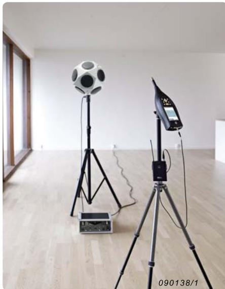
Le temps de réverbération se mesure à plusieurs points de réception suite à l'émission soit d'une impulsion sonore soit d'un bruit constant interrompu brusquement. C'est la moyenne des résultats obtenus à ces différentes positions qui est prise en compte.
