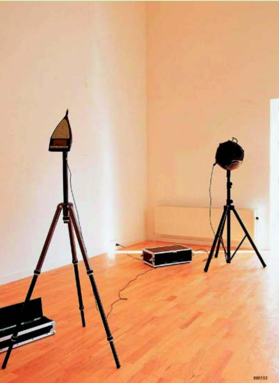
Le caratteristiche di Investigator 2260D combinate con il software per PC, Qualifier 7830, oppure del 2260G, combinate con il software Qualifier Light 7831, costituiscono insieme la soluzione ideale per poter effettuare misure ed analisi di acustica architettonica.
