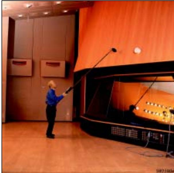
Come alternativa ad una misura dell'indice di isolamento acustico apparente  $R'$ , per una data partizione, che si basa sulla pressione sonora, questo sistema di misura consente di misurare il corretto indice di riduzione dell'intensità sonora  $R_{I,C}$ . In questo modo si ottengono molte più informazioni che riguardano il contributo proveniente dalle varie trasmissioni addizionali e
