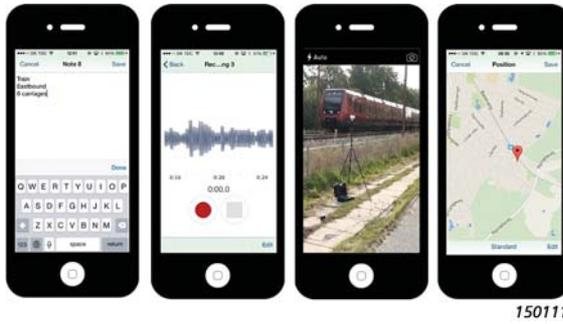
Una vez establecida la conexión con el analizador, podrá iniciar, detener o pausar la medición desde una distancia segura. Durante las mediciones de ruido, el perfil LAF instantáneo se mostrará en la aplicación de campo.
