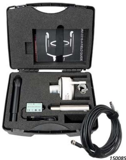
Las estaciones meteorológicas se basan en tecnologías de ultrasonido y funcionan bien por encima del límite de frecuencia superior del micrófono. Conecte la estación meteorológica al analizador, enciéndalo y ya estará listo para realizar mediciones sin tener que realizar ningún tipo de instalación de software. La estación meteorológica se alimenta de la batería del analizador, por lo que no necesitará ninguna batería adicional.
