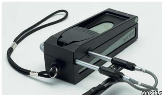
Mit dem Schallintensitätskalibrator Typ 4297 ist eine komplette Kalibrierung möglich. Sie umfasst die Druckkalibrierung beider Kanäle, Phasenkalibrierung beider Kanäle und Verifizierung der Querfeldunterdrückung. Durch Phasenkalibrierung wird die Dynamik verbessert und der mit einem 12 mm-Distanzstück messbare Frequenzbereich nach unten bis auf 50 Hz erweitert.
