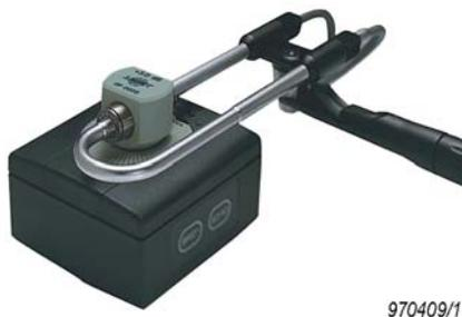
Die Druckkalibrierung kann separat mit dem Schallkalibrator Typ 4231 und dem Intensitätsadapter DP-0888 bei 97 dB  $\pm$  0,7 dB bei 1 kHz durchgeführt werden.
