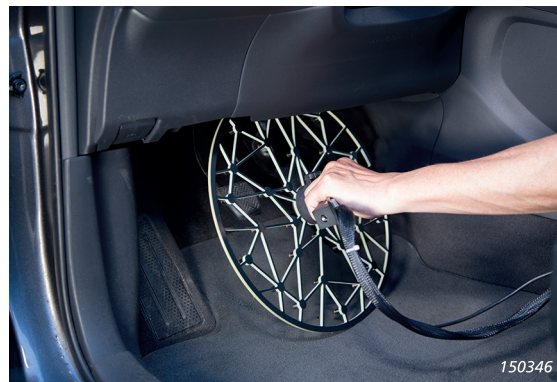
図 4 左：WA-1764-W-001 ハンドヘルドアレイのビームフォーミング計測での使用例 (反射板を装着した状態) 右：音響ホログラフィ計測時の使用例 (反射板およびタブレットを取り外した状態)
