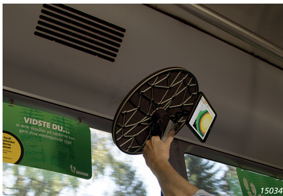
図 4 左：WA-1764-W-001 ハンドヘルドアレイのビームフォーミング計測での使用例 (反射板を装着した状態) 右：音響ホログラフィ計測時の使用例 (反射板およびタブレットを取り外した状態)
