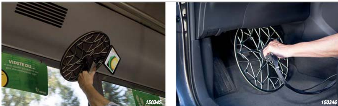
图 4 WA-1764-W-001 手持阵列安装反射板时用于波束成形测量（左），未安装反射板时用于声全息测量（右）
