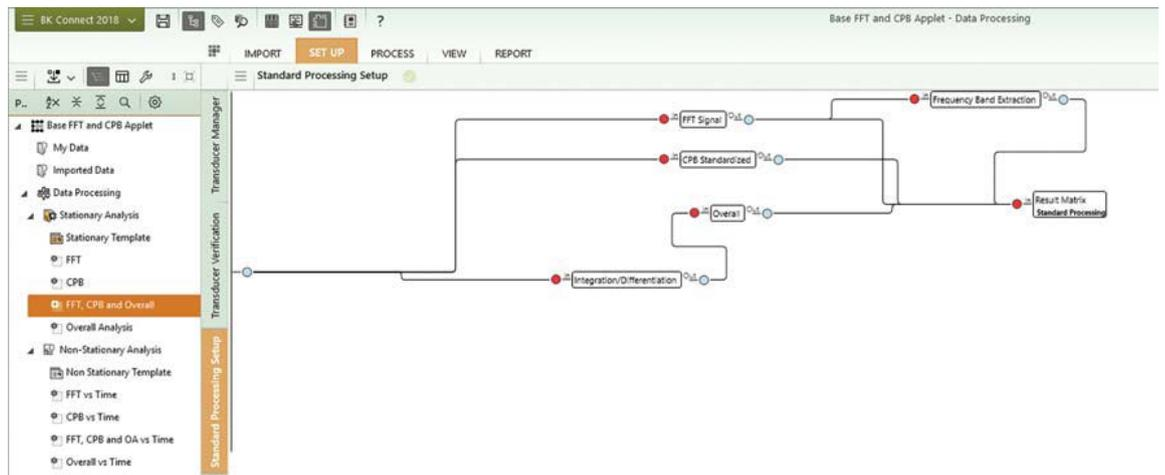
对于每个设置，都会预先配置一整套实时监控器，并预定义一个目标流程（分析）链 – 为您开始分析做好准备。如果需要，您可以根据自己的测试规范调整显示器参数和分析属性。准备就绪后，使用位于监视器中的简单记录仪记录数据。
