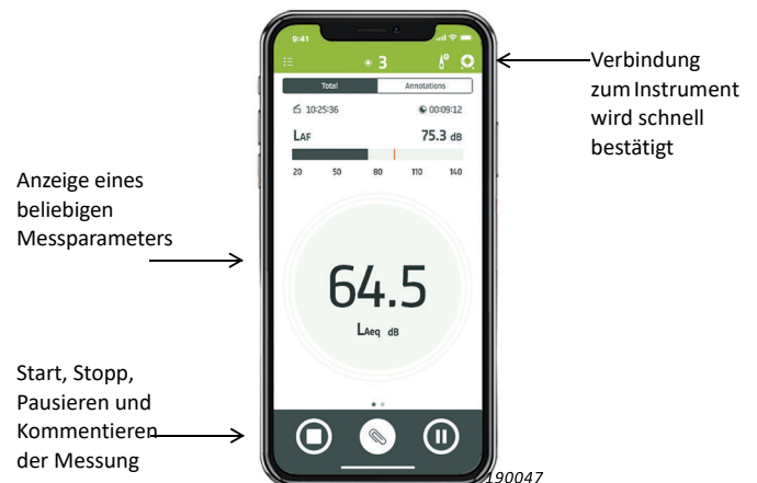
Abb. 3 Messungen werden direkt vom Mobilgerät aus gesteuert, angezeigt und kommentiert
