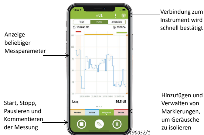
Abb. 2 Messungen werden direkt vom Mobilgerät aus gesteuert, angezeigt und kommentiert
