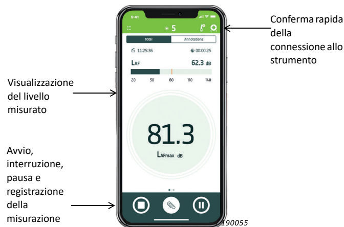
Fig. 2 Controlla, visualizza e annota le misurazioni direttamente dal dispositivo mobile
