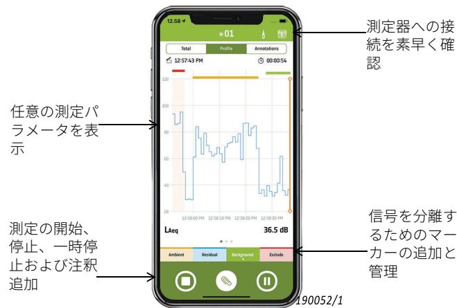
図2 モバイルデバイスから直接測定のコントロール、表示、注釈追加が可能
