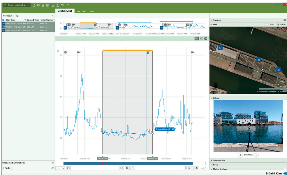
図 4 PC ソフトウェアに表示される転送データ - このまま後処理およびレポート作成が可能
