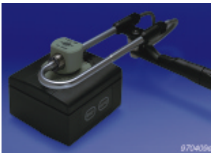
Fig. 6 Calibrage en pression au moyen d'un calibre de sonomètre
