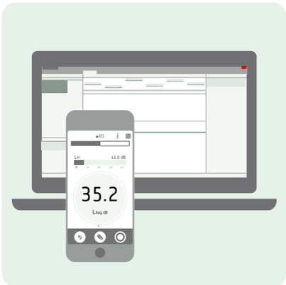
Die Mobilgeräte-App verbindet sich mit dem Instrument und fungiert dann als Fernbedienung, die Sie bei der Einrichtung unterstützt. Darüber hinaus können Sie die Messung mit Hilfe der Funktionen Ihres Mobilgerätes mit Fotos, Videos, Notizen und Kommentaren dokumentieren. Nachdem Sie eine Messung durchgeführt haben, können Sie mit der PC-Anwendung Daten einsehen, verarbeiten und Ihre Ergebnisse in Berichten zusammenfassen.
