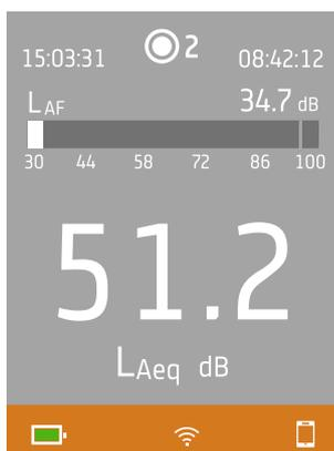
Der untere Bereich enthält Informationen über das System: Batterie-, Netzwerk- und Verbindungsstatus.
