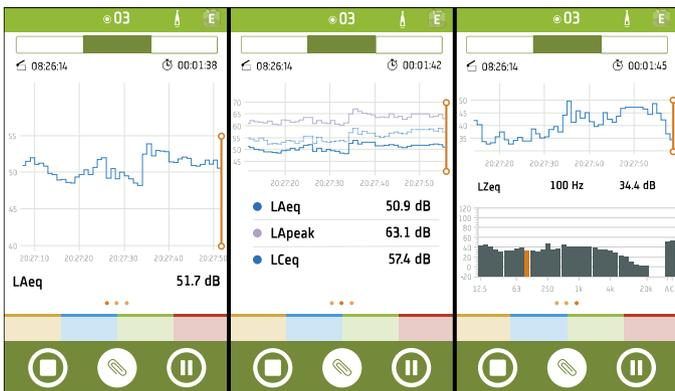
**Profil** affiche les paramètres à large bande et/ou spectraux enregistrés (Vue Profil). Il s'agit de l'écran principal des mesures enregistrées.
