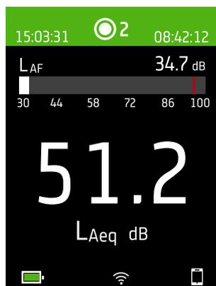
Ceci est un exemple de l'interface utilisateur graphique (GUI, Graphical user interface) de l'appareil dans une thématique couleurs sombre lors du mesurage et en connexion avec l'application mobile.
