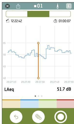
Si può passare da Totale a Profilo e da Visualizzazione SLM a Visualizzazione elenco e a Visualizzazione spettro.
