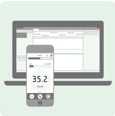
L'app mobile si collega allo strumento, consentendo di controllarlo a distanza e guidando l'utente nella procedura di configurazione. Consente inoltre di documentare le misure con foto, video, note e commenti attraverso le funzionalità del dispositivo mobile. Dopo avere acquisito una misura, si utilizzerà l'applicazione per PC per visualizzare ed elaborare i dati e creare report con i risultati.
