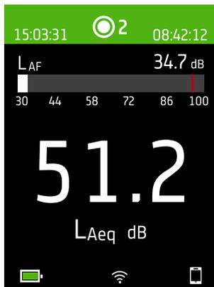
Dies ist ein Beispiel für die grafische Benutzerschnittstelle (GUI) des Instruments in dunklem Farbschema während einer Messung mit Verbindung zur Mobilgeräte-App.
