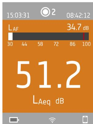
Al centro si trova il display delle misure. Vi sono viste per i parametri a banda larga (Visualizzazione SLM e Visualizzazione elenco) e una vista per le informazioni sui dati (Visualizzazione Info dati).
