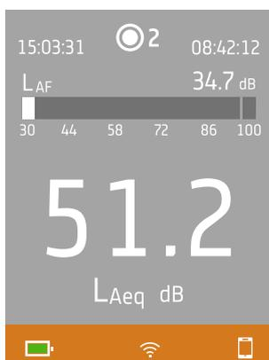
L'area inferiore fornisce informazioni sul sistema: batteria, rete e stato di connettività.
