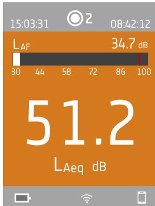
Drücken Sie kurz auf ▲ und ▼, um durch die Messwertanzeigen zu scrollen. Drücken Sie kurz auf ◀ und ▶, um durch die Parameter der einzelnen Anzeigen zu scrollen.
