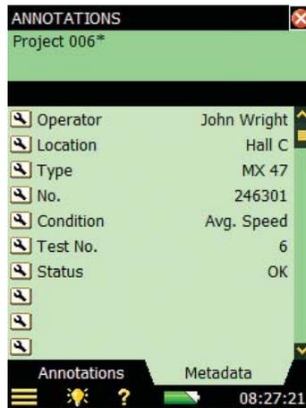
Los metadatos pueden ser números o texto, se pueden introducir o cambiar fácilmente usando el teclado y también seleccionarse de una lista definida por el usuario. Los metadatos se guardan en el proyecto junto a las mediciones. Consulte la sección 8.7 para una descripción más completa de la forma de usar los metadatos.
