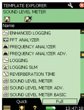
La primera línea del campo de estado ("Sonómetro" en la Fig.4.8) contiene el nombre de la plantilla que se está utilizando en ese momento. Si modifica la configuración de la plantilla de proyecto, aparecerá un "\*" junto al nombre de la plantilla, para indicar que la nueva configuración no se ha guardado.
