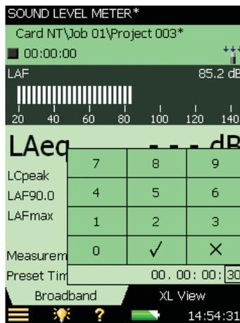
Pulse los dígitos con el puntero o utilice los botones **Flecha hacia arriba** ▲ y **Flecha hacia abajo** ▼ para aumentar o disminuir el valor. Los botones **Flecha izquierda** ← y **Flecha derecha** → permiten seleccionar otros dígitos. Pulse el botón **Aceptar** (✓) o pulse el [✓] en el teclado numérico para confirmar el valor seleccionado para el parámetro. Pulse el botón [✗] en el teclado numérico, o pulse en cualquier parte fuera del teclado numérico para cancelar el cambio de valor.
