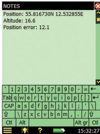
Si no tiene un receptor GPS pero conoce la ubicación (por ejemplo, porque se la proporciona su teléfono móvil), puede introducirla manualmente en la nota GPS.
