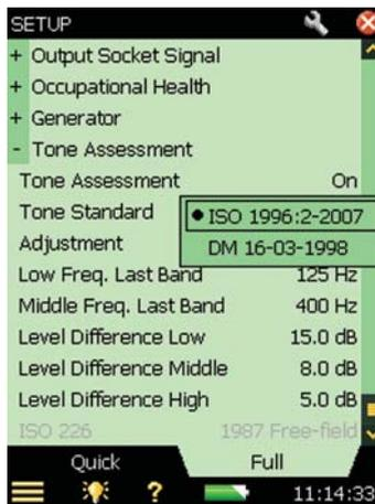
Si selecciona el método de evaluación tonal según la norma ISO 1996-2, Anexo D, puede aceptar la configuración por defecto conforme con dicha norma. Después podrá cambiar los distintos parámetros en función de sus necesidades (excepto el parámetro *ISO 226*, que está fijo en gris) y proceder directamente a las mediciones.
