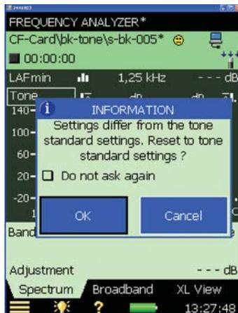
Puede desactivar la ventana para el resto de la sesión de medición. Para volver a activarla tendrá que volver a cargar la plantilla o reiniciar el analizador. Esta comprobación automática se desactiva cuando **Menú principal** (☰) > **Configuración** > **Evaluación tonal** > **Evaluación tonal** se pone en *No*.
