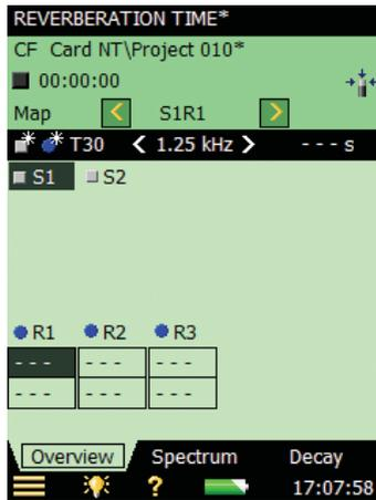
Para desplazar las fuentes o los receptores en el mapa, pulse en la fuente o receptor que quiera cambiar de posición (Fig.14.13), seleccione la opción *Mover* del menú desplegable que aparece y luego pulse con el puntero en el lugar donde quiera colocar la fuente/receptor (Fig.14.14).
