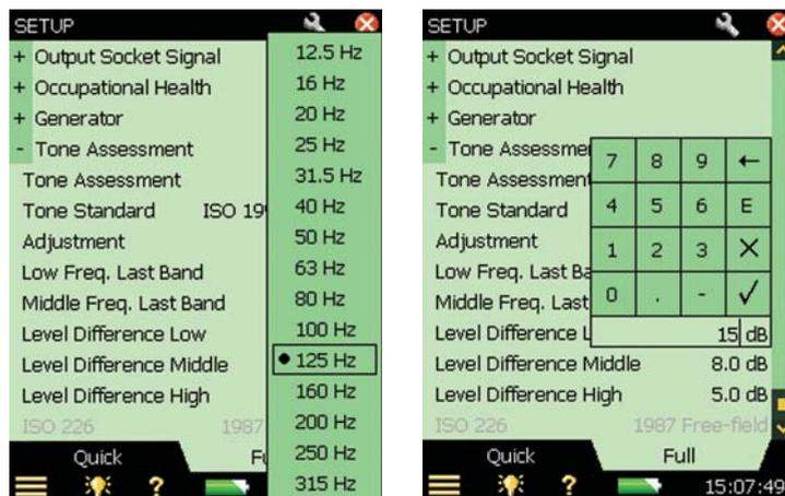
Para definir la división entre los intervalos de baja y media frecuencia, seleccione el valor requerido para la *Última banda* (o la más alta) del intervalo de baja frecuencia (de 12,5 Hz a 315 Hz) y defina la división entre los intervalos de media y alta frecuencia, seleccionando el valor requerido para la *Última banda* (o la más alta) del intervalo de frecuencia media (de 160 Hz a 20 kHz).
