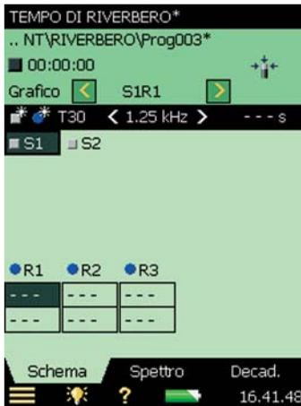
Le sorgenti ed i ricevitori possono essere spostati sul grafico. Toccare su di essi (si veda la Fig.14.13), selezionare *Sposta*, dal menu delle opzioni e toccare sulla posizione dove si vuole spostarli (si veda la Fig. 14.14).
