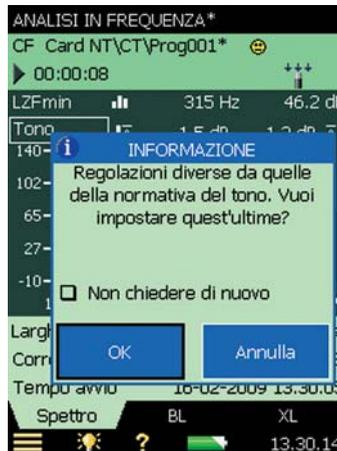
La finestra d'informazione può essere disattivata per il resto della sessione di misura. Per attivarla di nuovo, occorre ricaricare il template o riavviare lo strumento. Questo controllo automatico si disattiva quando il parametro *Valutazione tonale*, nel menu **Setup**, è impostato su *No*.
