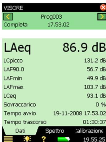
Tutti i valori misurati vengono visualizzati sotto le due righe superiori dell'area di visualizzazione: i dati fonometrici dal tabulatore **Dati** e le informazioni sullo spettro (solo per l'Analisi di frequenza) dal tabulatore **Spettro**. Toccando sui parametri dello spettro o sui parametri a banda larga, si selezionano altri parametri.
