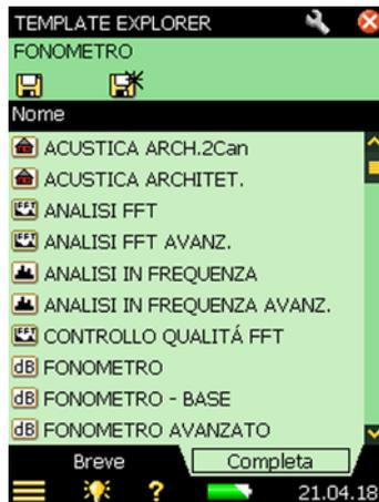
La riga superiore nell'area d'indicazione dello stato (FONOMETRO nella Fig.5.8) contiene il nome del template corrente. Effettuando delle modifiche alle regolazioni del template corrente, un asterisco "\*" apparirà accanto al nome ad indicare che le nuove regolazioni non sono state ancora salvate.
