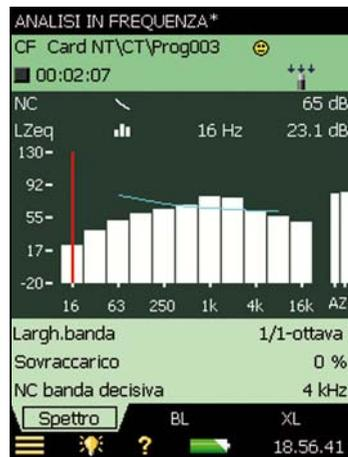
Per i parametri RC e NCB si ha anche la possibilità di visualizzare le curve limite per Rumble e Hiss, e per Rattle e Vibrazione insieme allo spettro  $L_{Zeq}$  in 1/1 d'ottava.
