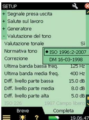
Se si seleziona il metodo di valutazione del tono in accordo alla normativa ISO 1996-2, allegato D, si può accettare la regolazione predefinita. Si possono modificare i diversi parametri a seconda delle necessità, eccetto quelli che non sono accessibili e procedere direttamente alla misura.
