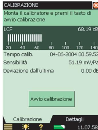
La finestra contiene un grafico a barre che indica il livello di pressione sonora reale e tre righe per la visualizzazione delle informazioni riguardanti l'ultima calibrazione.
