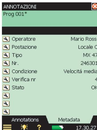
I metadata sono dei testi o numeri facilmente impostabili e modificabili usando la tastiera oppure possono essere selezionati da un elenco definito dall'utente. I metadata vengono memorizzati insieme alla misura nel progetto. Per una descrizione più approfondita sull'uso dei metadata, riferirsi alla sezione 8.7.
