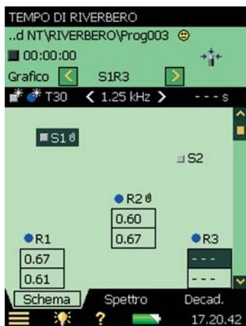
L'esempio nella Fig. 14.15 mostra lo stato quando quattro misure sono state seguite e salvate e viene selezionata la posizione S1R3, pronta per la misura successiva. Accanto ai risultati potrebbero apparire degli smiley – toccandoli si ottengono le informazioni sulla qualità della misura.
