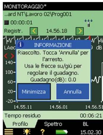
Una volta selezionato il modo di riproduzione, la finestra che si apre sullo schermo spiega come regolare il livello d'uscita auricolari e come arrestare l'ascolto.
