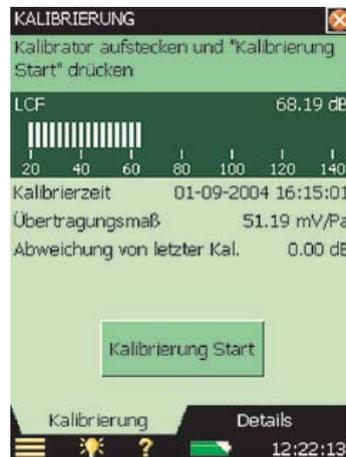
Diese Anzeige enthält ein Balkendiagramm mit dem aktuellen Schalldruckpegel und drei Eintragungen für Angaben zur letzten Kalibrierung.
