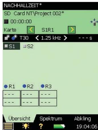
Sie können Sender und Empfänger auf der Karte verschieben, indem Sie den Sender/Empfänger auf der Karte antippen (siehe Abb. 14.13), im Dropdown-Menü *Verschieben* wählen und dann die neue Position antippen (siehe Abb. 14.14).
