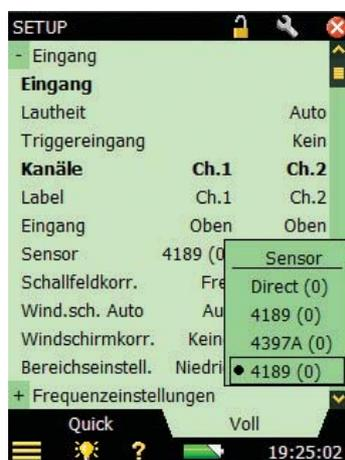
Um eine andere Beschriftung als Ch.1 und Ch.2 zu wählen (z. B. *Ein* für **Kan.1** und *Aus* für **Kan.2**), tippen Sie den **Label**-Parameter an und geben das neue Label ein.
