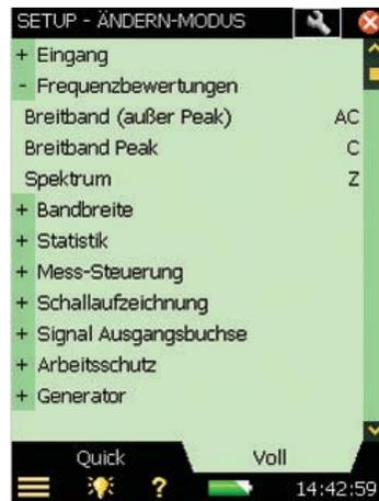
Mit dem Register **Voll** unten auf der Anzeige können Sie die komplette Liste der Setupparameter sehen, während **Quick** nur die am häufigsten verwendeten Parameter zeigt, die von Ihnen definiert wurden. Drücken Sie **Ändern**
