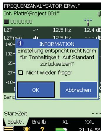
Das Popup-Fenster kann für den Rest der Messung deaktiviert werden. Um es erneut zu aktivieren, müssen Sie die Vorlage neu laden oder den Analysator neu starten. Diese automatische Überprüfung ist deaktiviert, wenn **Hauptmenü**
