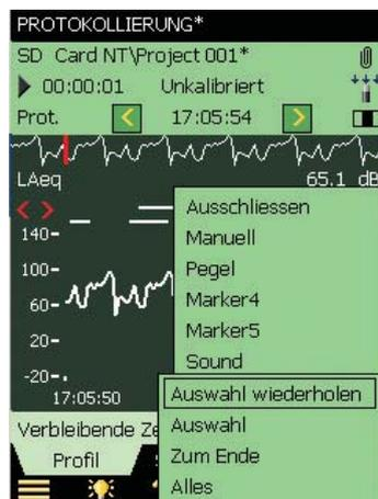
Für die Wiedergabe wählen Sie eine von vier Möglichkeiten: *Auswahl*. Der gewählte Teil wird abgespielt. *Auswahl wiederholen*. Der gewählte Teil wird abgespielt, bis im Popup-Menü *Abbrechen* gedrückt wird. *Zum Ende*. Ab der für die Sound-Marke gewählten Position wird bis zum Ende abgespielt. *Alle*. Die gesamte Signalaufzeichnung wird abgespielt, unabhängig vom Auswahlpunkt.
