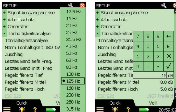
Sie bestimmen die Grenze zwischen dem tiefen/mittleren Frequenzbereich, indem Sie den gewünschten Wert für das *Letzte* (oder höchste) *Band* im tiefen Frequenzbereich (von 12,5 Hz bis 315 Hz) wählen, und bestimmen die Grenze zwischen dem mittleren/hohen Frequenzbereich, indem Sie den gewünschten Wert für das *Letzte* (oder höchste) *Band* im mittleren Frequenzbereich (von 160 Hz bis 20 kHz) wählen.
