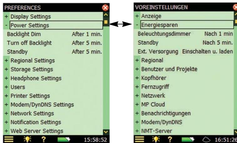
Die Hintergrundbeleuchtung wird eingeschaltet, sobald Sie den Analysator in Betrieb nehmen, entweder mit Hilfe der Tastatur oder mit dem Griffel auf dem Touchdisplay. Sie stellen eine von sechs Helligkeitsstufen ein, indem Sie unten auf dem Display antippen. Wählen Sie *Minimal* für geringste Helligkeit (und Stromverbrauch) und *Maximum* für größte Helligkeit (und Stromverbrauch). Wenn Sie die Stufe ausgewählt haben, wählen Sie *Schließen*, um die Einstellung zu speichern.
