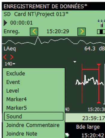
Le petit triangle au-dessus du Profil indique la quantité de bruit stockée dans la mémoire tampon, prête à être stockée dans un fichier wave, du triangle vers la droite du Profil. Ce triangle est repositionné toutes les secondes.
