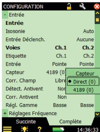
Pour choisir des étiquettes autres que Ch.1 et Ch.2 (par exemple, *Entrée* pour *Ch.1* et *Sortie* pour *Ch.2*), taper sur le paramètre *Etiquette* puis saisir le nouveau nom.
