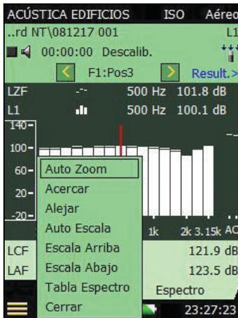
En área bajo el espectro, se muestran dos parámetros – ambos pueden seleccionarse de la lista desplegable, véase Fig.4.7.
