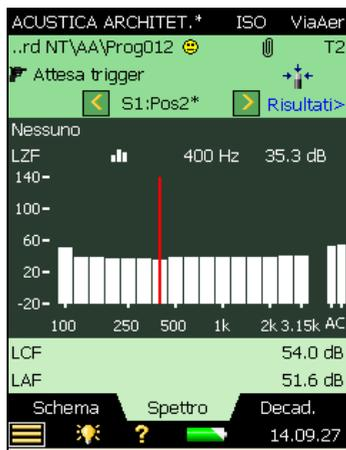
Il grafico principale dello spettro (quello con le barre) viene selezionato usando il selettore del parametro della seconda delle due righe mostrate sopra il grafico (LZF nella Fig.4.25), che è collegato al selettore nel display *Schema* e al selettore del parametro del decadimento principale nel display *Decad.*.
